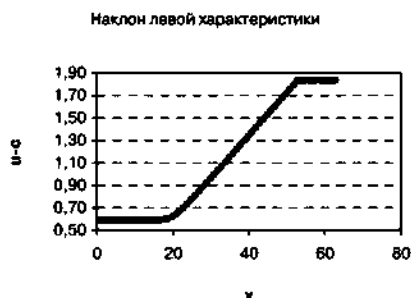
Рис. 1.73. Наклон левой характеристики в сверхзвуковой волне разрежения, рассчитанной в эйлеровых переменных. Всюду положительный
