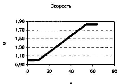
Рис. 1.75. Скорость потока в трансзвуковой волне разрежения, рассчитанной в эйлеровых переменных
