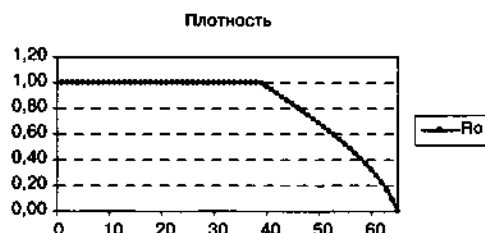
Рис. 1.38. График удельного объема в волне разрежения. Расчет по схеме «КАБАРЕ» в массовых переменных с коррекцией потоков. Аппроксимируется консервативная форма уравнений
