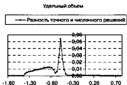
Рис. 1.60. График модуля отклонения консервативной переменной удельного объема от аналитического решения при числе расчетных ячеек N = 256
