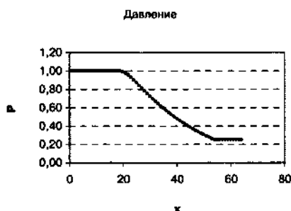
Рис. 1.74. Давление в сверхзвуковой волне разрежения, рассчитанной в эйлеровых переменных
