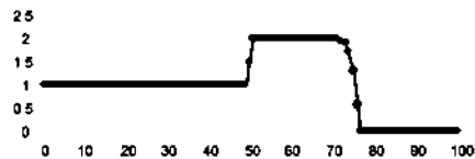
Рис. 1.25б. Переход через точку разрыва конвективной скорости, расположенной на середине области.
