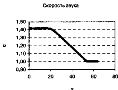
Рис. 1.72. Скорость звука в сверхзвуковой волне разрежения, рассчитанной в эйлеровых переменных
