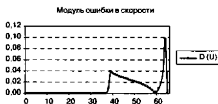
Рис. 1.39. График модуля ошибки в скорости волны разрежения. Расчет по схеме «КАБАРЕ» в массовых переменных с коррекцией потоков. Аппроксимируется консервативная форма уравнений
