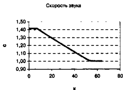
Рис. 1.68. Скорость звука в дозвуковой волне разрежения, рассчитанной в эйлеровых переменных
