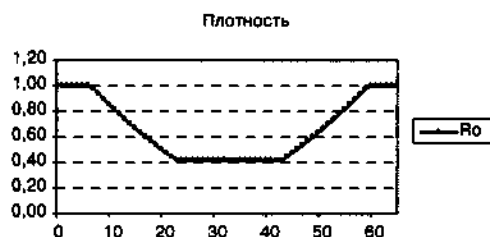
Рис. 1.84. График плотности при расчете автомодельной задачи о двух волнах разрежения. Расчет в зйлеровых переменных
