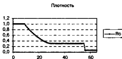
Рис. 1.90. График плотности при расчете автомодельной задачи об ударной волне и волне разрежения. Расчет в эйлеровых переменных. N = 64
