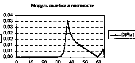
Рис. 1.44. График модуля ошибки в плотности при расчете волны разрежения. Расчет по схеме «крест» в массовых переменных с коррекцией потоков. Аппроксимируется консервативная форма уравнений
