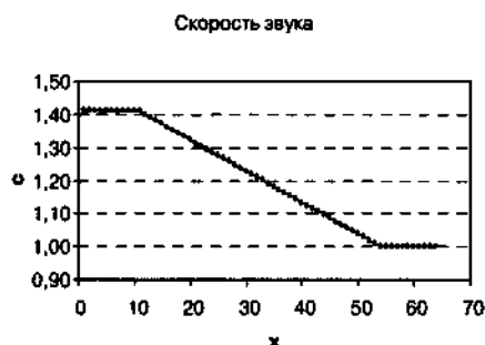
Рис. 1.76. Скорость звука в трансзвуковой волне разрежения, рассчитанной в эйлеровых переменных
