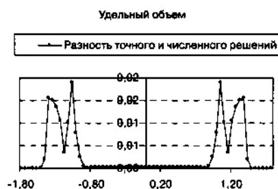
Рис. 1.54. График модуля отклонения консервативной переменной удельного объема от аналитического решения при числе расчетных ячеек N = 256
