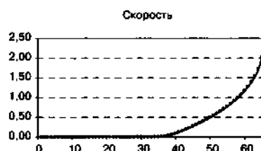
Рис. 1.41. График скорости в волне разрежения. Расчет по схеме «крест» в массовых переменных с коррекцией потоков. Аппроксимируется консервативная форма уравнений
