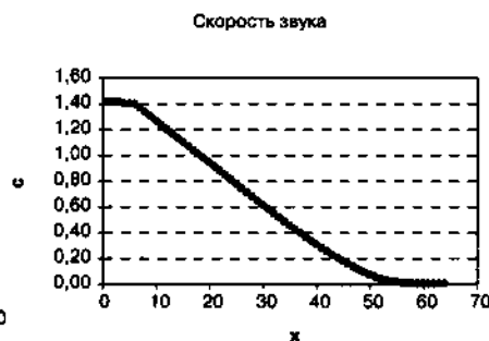
Рис. 1.80. Скорость звука при разлете газа в пустоту. Расчет в эйлеровых переменных
