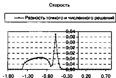
Рис. 1.59. График модуля отклонения консервативной скорости от аналитического решения при числе расчетных ячеек N = 256
