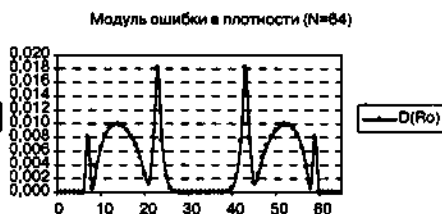
Рис. 1.86. Модуль ошибки плотности при расчете автомодельной задачи о двух волнах разрежения. Расчет в зйлеровых переменных. N = 64
