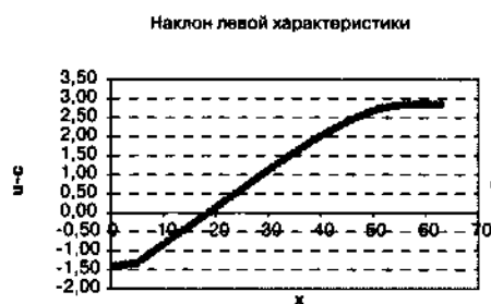
Рис. 1.79. Скорость потока при разлете газа в пустоту. Расчет в эйлеровых переменных
