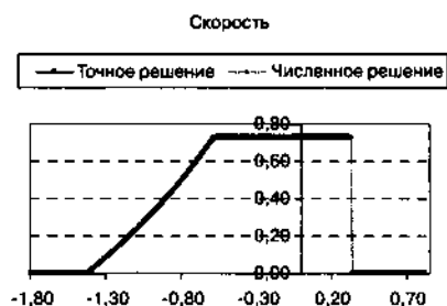
Рис. 1.57. График консервативной скорости в автомодельной задаче об ударной волне и волне разрежения. N = 256
