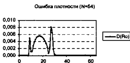
Рис. 1.92. График модуля ошибки плотности при расчете автомодельной задачи об ударной волне и волне разрежения. Расчет в эйлеровых переменных. N = 64
