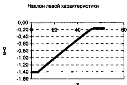
Рис. 1.69. Наклон левой характеристики в дозвуковой волне разрежения, рассчитанной в эйлеровых переменных. Всюду отрицателен
