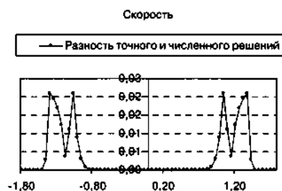
Рис. 1.53. График модуля отклонения консервативной скорости от аналитического решения при числе расчетных ячеек N = 256
