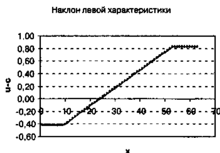
Рис. 1.77. Наклон левой характеристики в трансзвуковой волне разрежения в эйлеровых переменных. При переходе через «звуковую точку» наклон характеристики меняет знак
