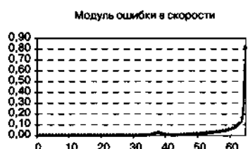
Рис. 1.43. График модуля ошибки в скорости волны разрежения. Расчет по схеме «крест» в массовых переменных с коррекцией потоков. Аппроксимируется консервативная форма уравнений
